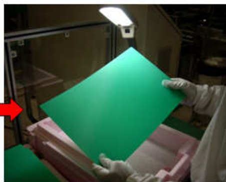
3. 檢查SPACER有無破損及刮傷
