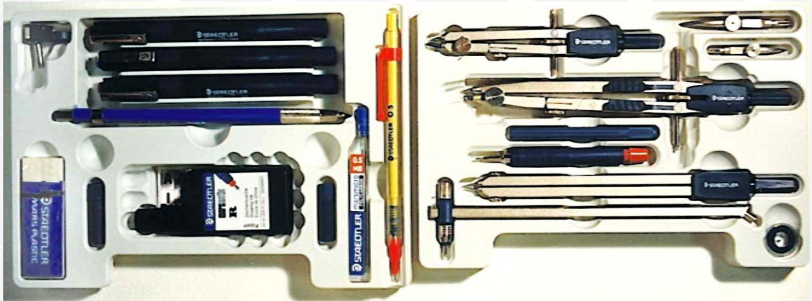
圖2-30 一組完整的製圖儀器（包含有自動鉛筆、各式針筆、墨水、圓規、分規、鴨嘴筆、延伸桿等）。
