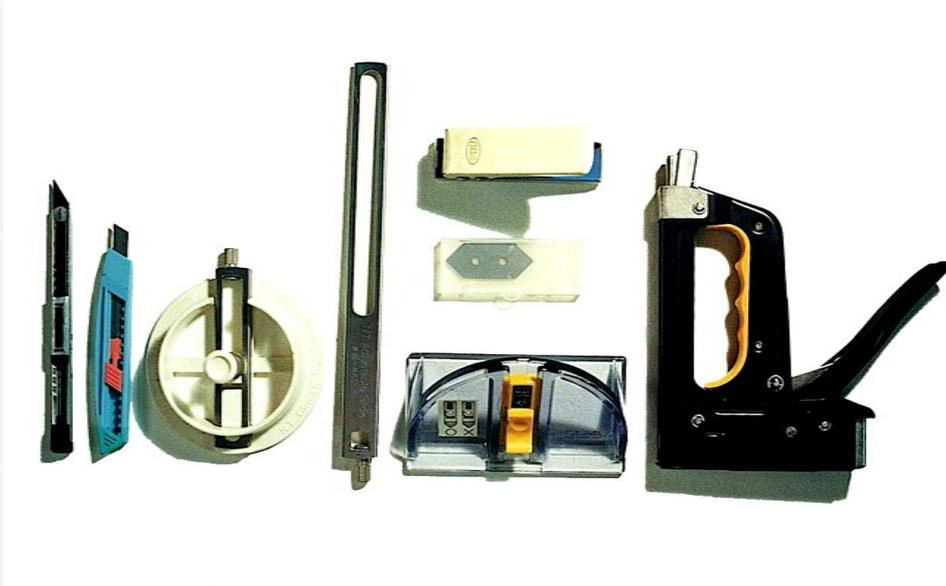
圖2-43 美工刀及切圓器等加工用具（打孔機、釘槍、45°裁切器）。
