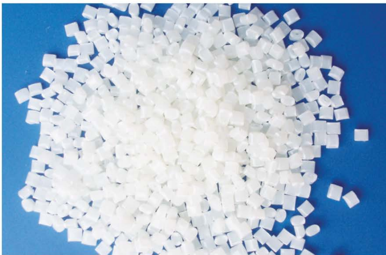
圖4-1 塑膠的平常狀態通常為固體—ABS塑膠粒
