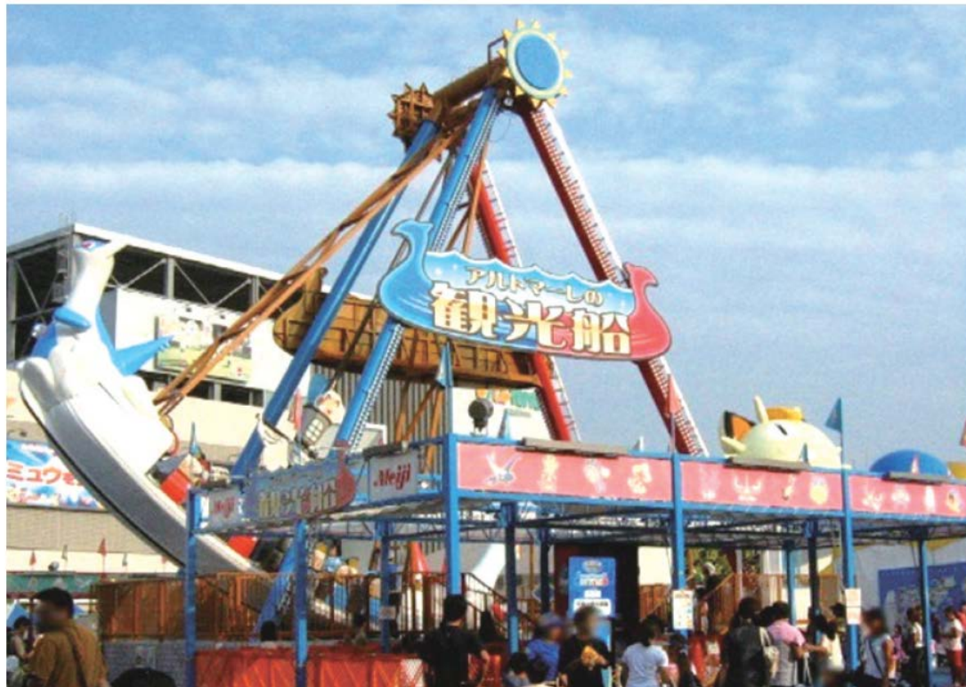
圖4-127 利用重力來產生動態平衡的海盜船遊樂設施
