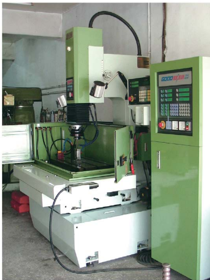
圖4-19 放電加工機被廣泛應用於模具工業上的加工
