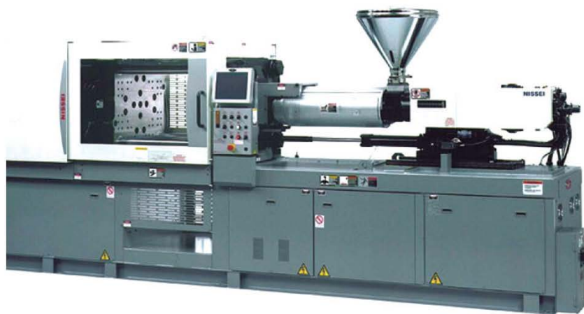
圖4-7 射出成形是最常見的一種塑膠成形法 (塑膠射出成形機)
